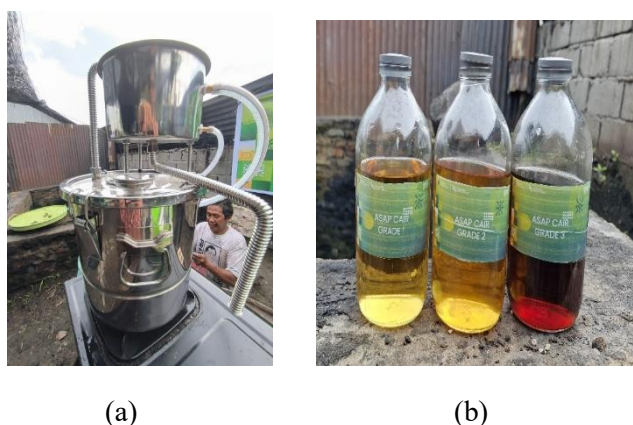
Gambar 3. Peralatan distilasi untuk menghasilkan asap cair grade 2 (a) dan asap cair grade 2 yang dihasilkan (b)
